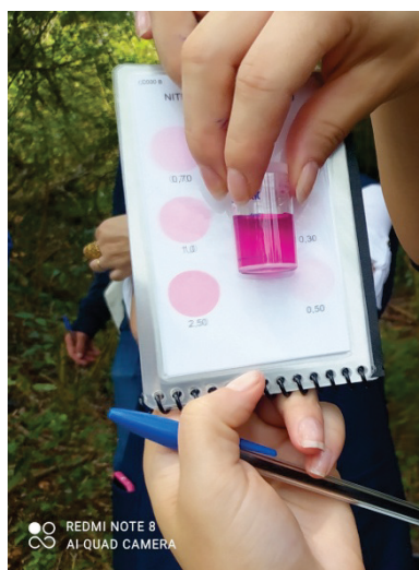
Figura 4 - Exemplo de análise através de padrão colorimétrico da amostra para nitrato.
