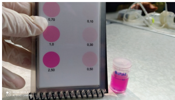
Figura 15 – Exemplo de análise do Nitrato e seu padrão colorimétrico no manual do Ecokit.
