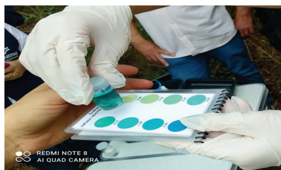
Figura 16 – Exemplo de análise da Amônia e seu padrão colorimétrico no manual do Ecokit.
