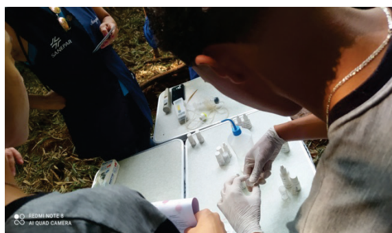
Figura 14 – Realização das análises químicas da amostra de água da nascente.
